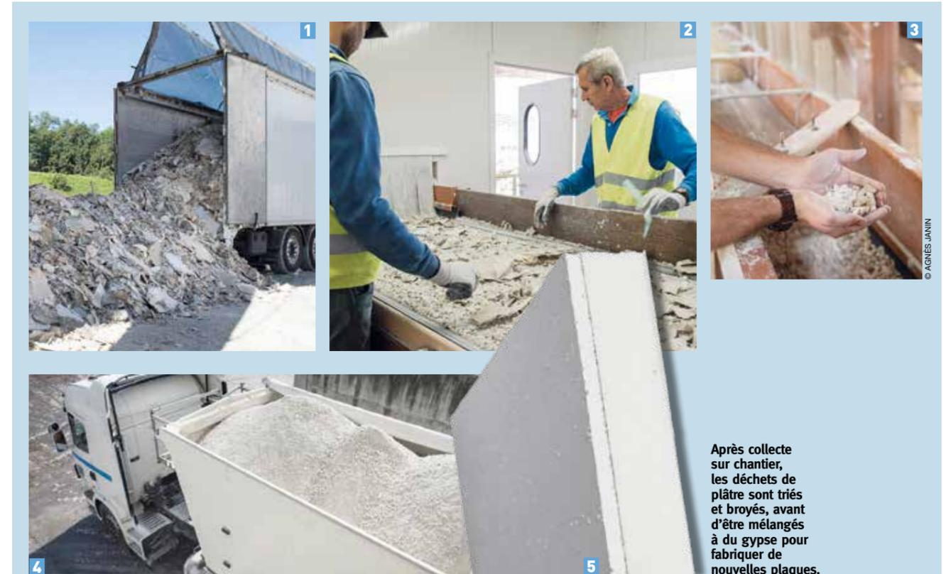
Après collecte sur chantier, les déchets de plâtre sont triés et broyés, avant d'être mélangés à du gypse pour fabriquer de nouvelles plaques.
